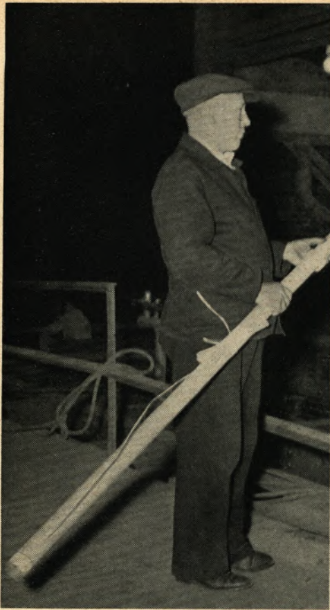
So sieht das Schießisen, in Amerika „Jet Tapper“ genannt, aus: Vorne der Kopf mit der Sprengladung, dahinter ein Papprohr mit Zünder und Zündschnur.
